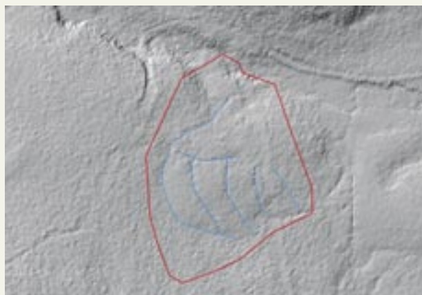
Fig. 246: Scheme of the drainage based on LIDAR images, Střelecký průsmyk
