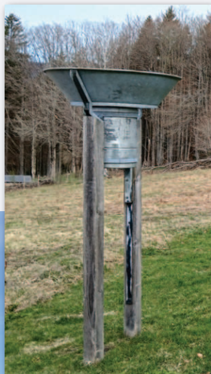
Totalizátor – srážkoměr, který se používá především v horských oblastech k zaznamenávání celkového množství srážek za delší období (např. 1 měsíc)
