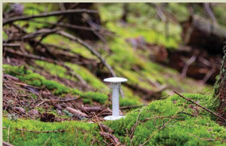
Mikroklimatické čidlo TMS4 měřící teplotu vzduchu a teplotu a vlhkost půdy instalované v horské smrčtině.
