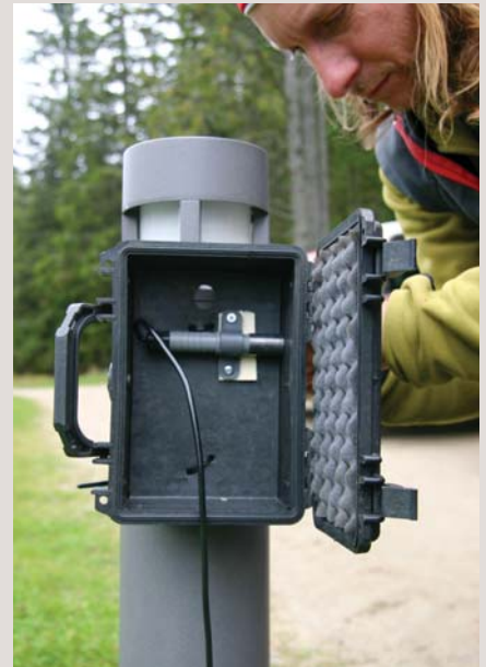
Tepelné čidlo je umístěno buď do vodotěsného "kufříku" nebo zabudováno do dřevěného sloupku u cesty.
