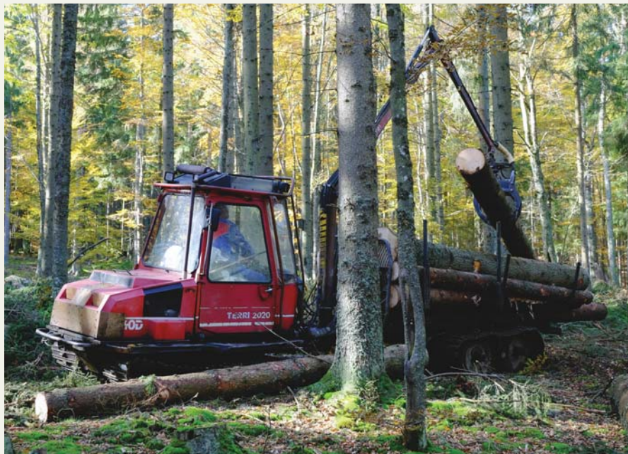
Těžební stroje (harvestory) rychle pokácí, odvětví a roztřídí stromy tak, aby je bylo možné vyvézt bez kontaktu dříví s půdou a stojícími stromy. Foto: Václav Hřebek
