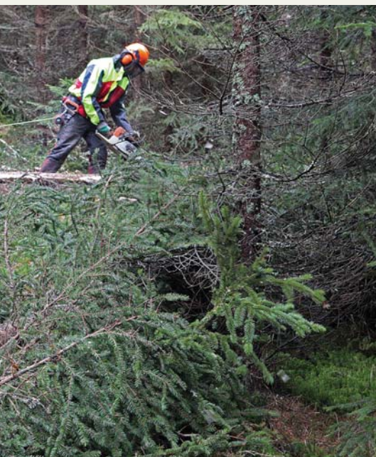
Ruční těžba je vhodná zejména tam, kde je potřeba zpracovat větší a tlustší stromy, při těžbě tenkých stromů není efektivní. Foto: Václav Hřebek
