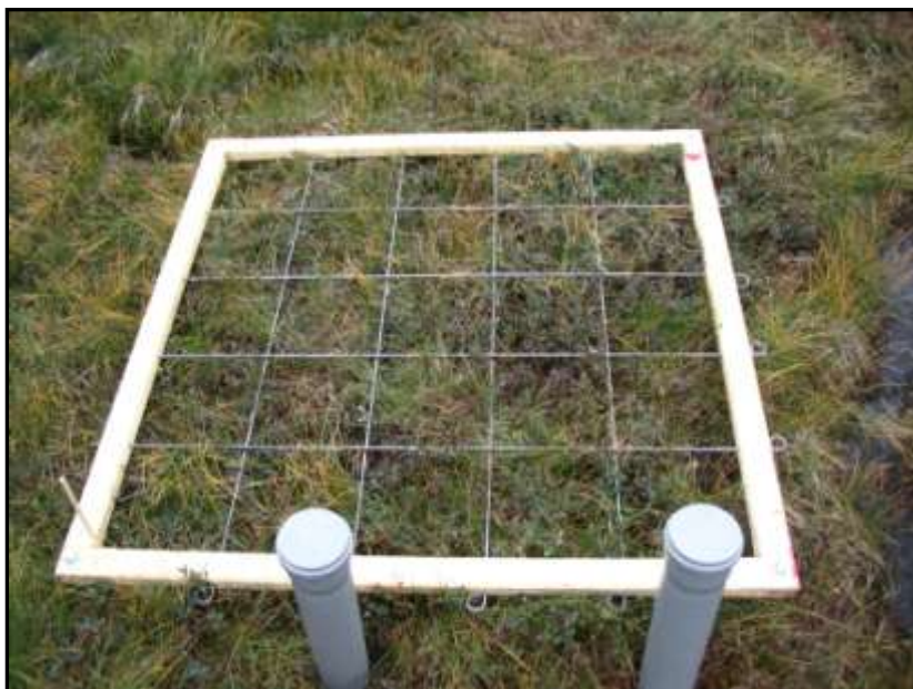
Ukázka sondy pro měření vody a trvalá plocha pro sledování vegetace (Blatenská slat') v rámci monitoringu rašelinišť. (foto: Iva Bufková)
