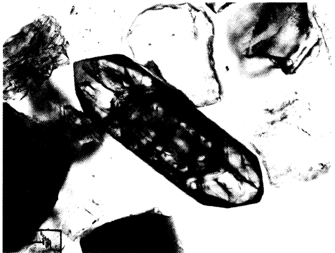
Abb. 4. – Zirkonkristalle mit Einschlüssen von Turmalin, Rutil und Apatit und Wachstumszonen von Jandelsbrunn/Passauer Wald. Messbalken bei Fotos 1 und 3 entspricht 20 \mu , bei Fotos 4 bis 6 \approx 50 \check{e} .
