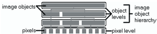
Obr. 3. Multi-úrovňové vztahy objektové hierarchie. Struktury (objekty) různých měřítek mohou být reprezentovány simultánně a tudíž klasifikovány pomocí vzájemných vztahů (DEFINIENS IMAGING 2006).
